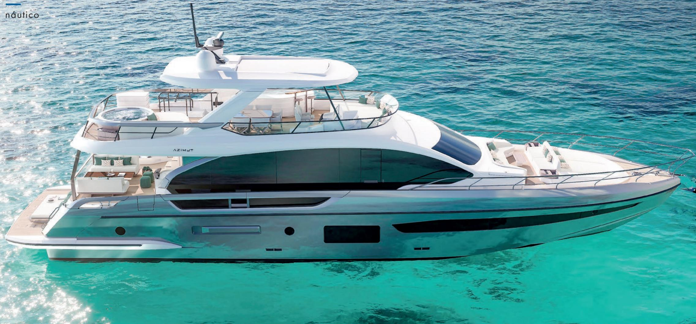
Em termos de desempenho, a 25 Metri combina conforto e potência. Os dois motores MAN V12 de 1800 HP permitem atingir até 29 nós de velocidade máxima e oferecem autonomia de até 14 horas. A navegação silenciosa é resultado da combinação entre engenharia avançada, materiais leves e isolamento acústico. O sistema de controle com joystick garante manobras precisas, mesmo em espaços reduzidos.
