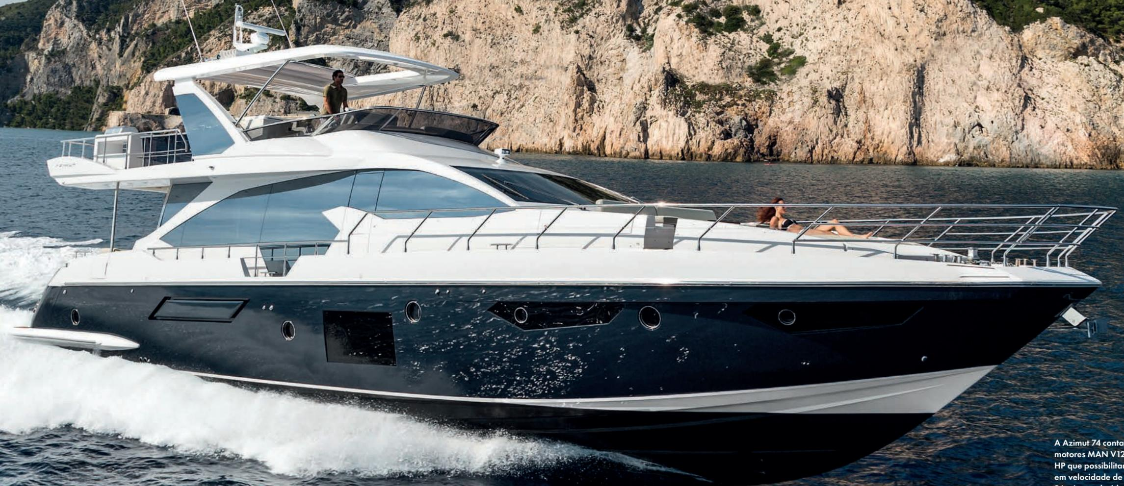
A Azimut 74 conta com dois motores MAN V12 de 1400 HP que possibilitam navegar, em velocidade de cruzeiro, a 26 nós, e velocidade máxima de 31 nós.
